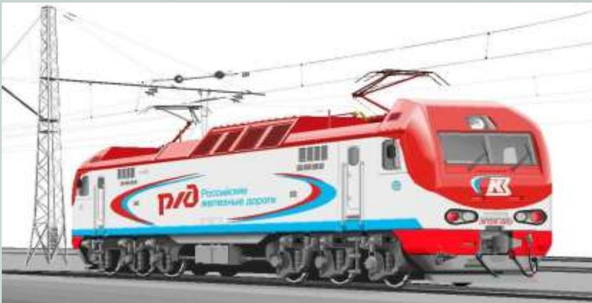
**ЭЛЕКТРОВОЗ** – не автономный локомотив, приводимый в движение установленным на нем тяговыми электродвигателями, питаемыми электроэнергией из внешней электросети через тяговые подстанции, через контактную сеть.
