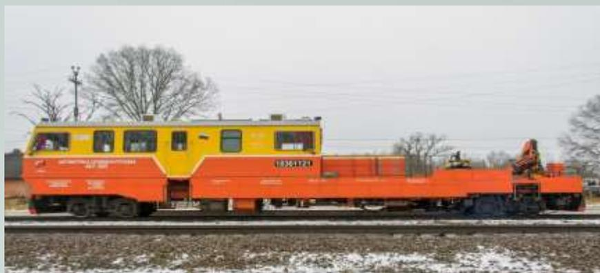
**АВТОМОТРИСА** – это специальный вид железнодорожного вагона, который имеет свой собственный двигатель. Используется для перевозки пассажиров и грузов по железной дороге.
