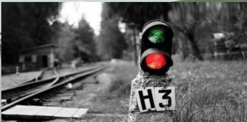
**СЕМАФОР** - сигнальный столб на железнодорожных путях, указывающий машинисту, закрыт или открыт путь для движения поезда.
