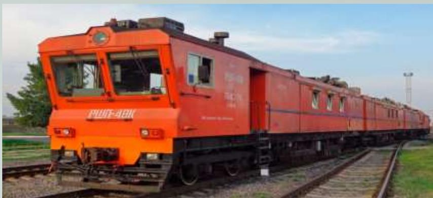
**РЕЛЬСОШЛИФОВАЛЬНЫЙ ПОЕЗД** – подвижной состав, предназначенный для устранения дефектов и волнообразных неровностях на железной дороге.
