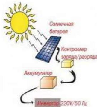
**СОЛНЕЧНАЯ БАТАРЕЯ** - устройство, преобразующее энергию солнечного света в электричество.
