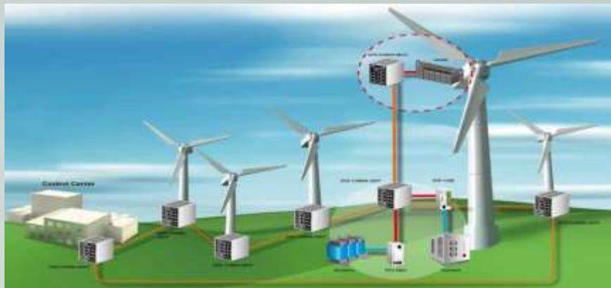
**ВЕТРОГЕНЕРАТОР** – устройство для преобразования энергии ветра в механическую энергию вращения ротора с последующим ее преобразованием в электрическую энергию.
