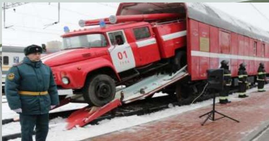
**ПОЖАРНЫЙ ПОЕЗД** – состав, предназначенный для тушения пожаров на железной дороге и на объектах, расположенных рядом.
