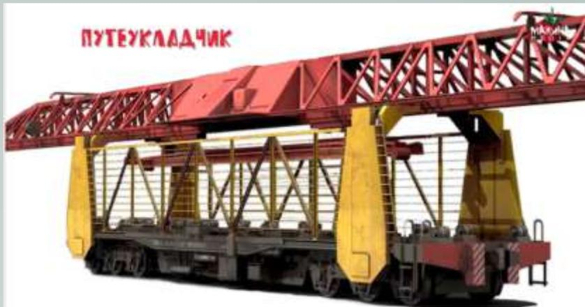
**ПУТЕУКЛАДЧИК** – это комплект машин для транспортировки и укладки рельсошпальной решетки при строительстве новых и ремонте старых железных дорог.
